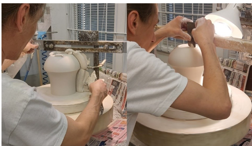
Kuva 22. Sapluunan käyttö prototypoinnissa ja jalkarengaan muokkaus.
