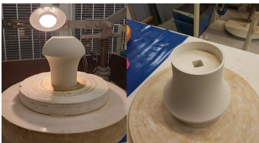
Kuva 23. Valmis prototyyppi alustassa ylösalaisin ja sisemmän mallineen poisto.
