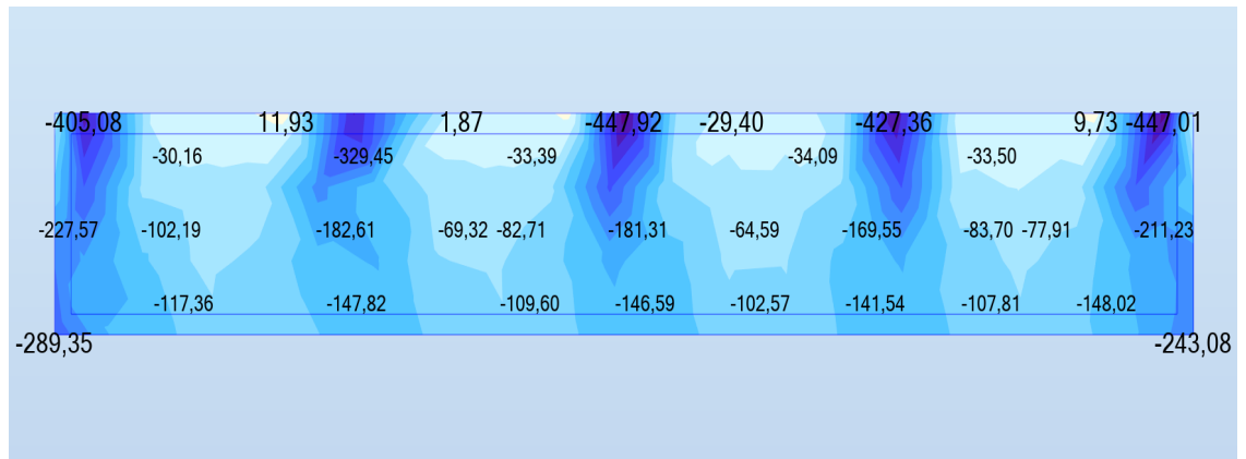
Kuva 24. Kantavan seinän normaalivoima pystysuunnassa.
