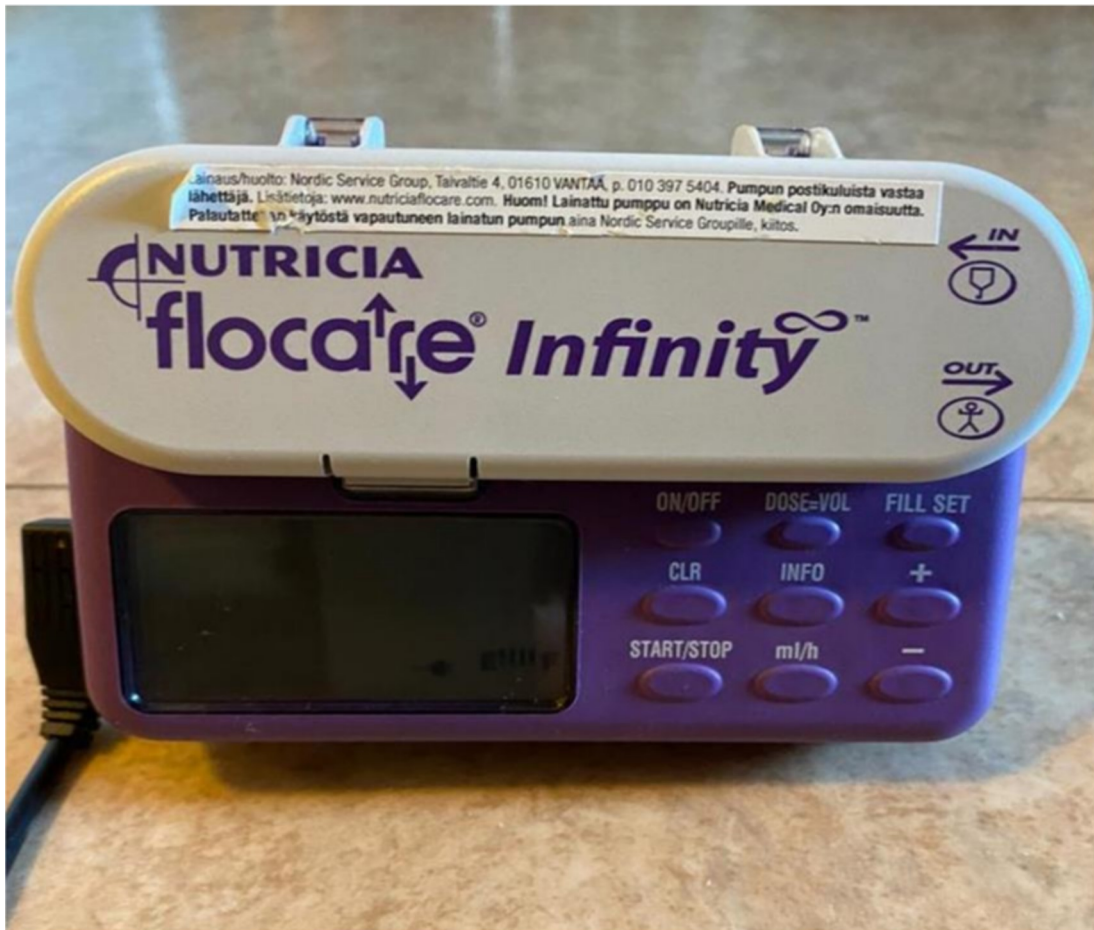
Kuva 2. Syöttöpumppu. (kuva: Lauri Tomberg 2020.)
