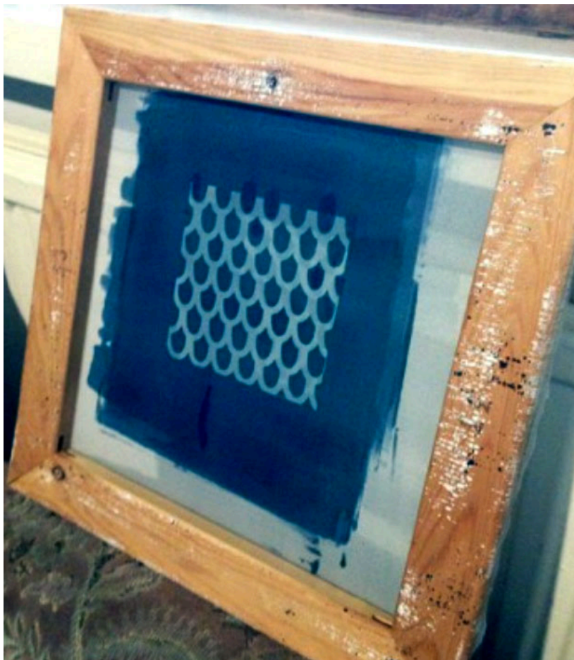
Kuva 18. Valotusseula kuivumassa vuotokohtien paikkauksen jälkeen
