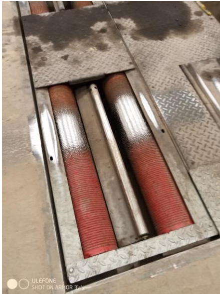
Kuva 2. 2-pyöräjarrudynamometri, jossa on näppylätelat.
