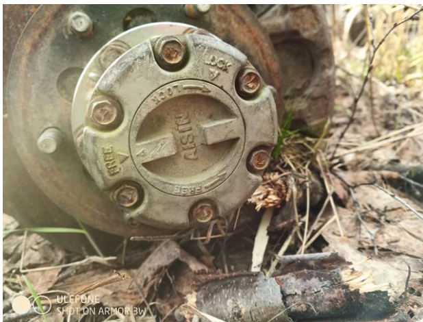
Kuva 7. Mitsubishi Pajeron manuaalinen napalukko. Kuvassa napalukko on kytketty “free”-asentoon, joten yhteys napojen ja vetoakseleiden välillä on katkaistu. Veto ei välity etupyörille, vaikka neliveto olisi kytketty.
