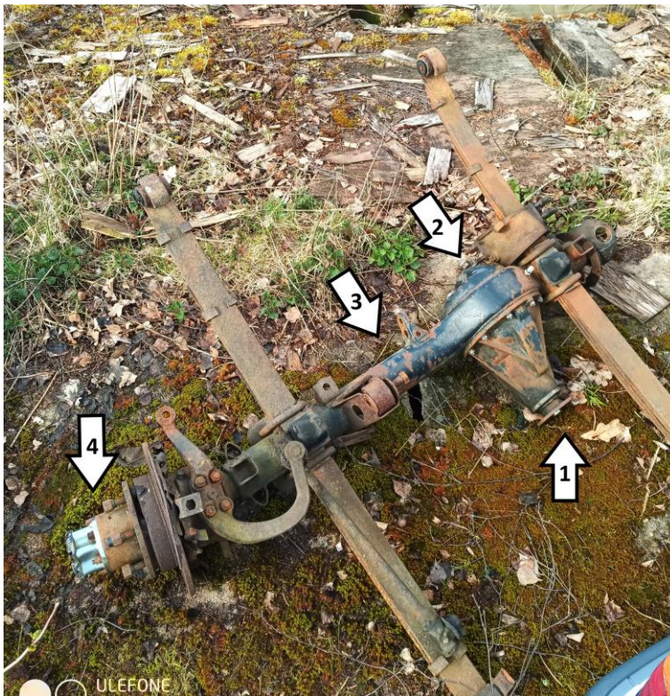
Kuva 5. Toyota Hiluxin etuakse- listo 1. Laippa, johon etukardaaniakseli kiinnittyy 2. Etutasaus- pyörästä 3. Akseliputki, jonka sisällä on vetoakselit 4. Napalukko.
