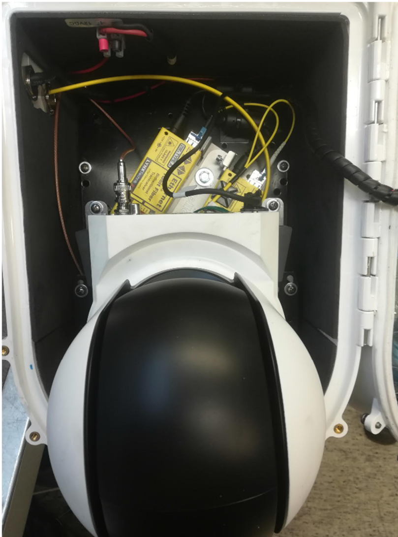
KUVA 13. Kääntyvän kameran kamerakotelo komponentteineen.
