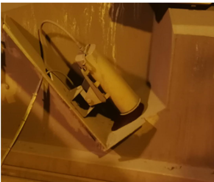
KUVA 4. Teräksestä valmistettu ja paineilmalla jäähdytetty kamerakotelo.
