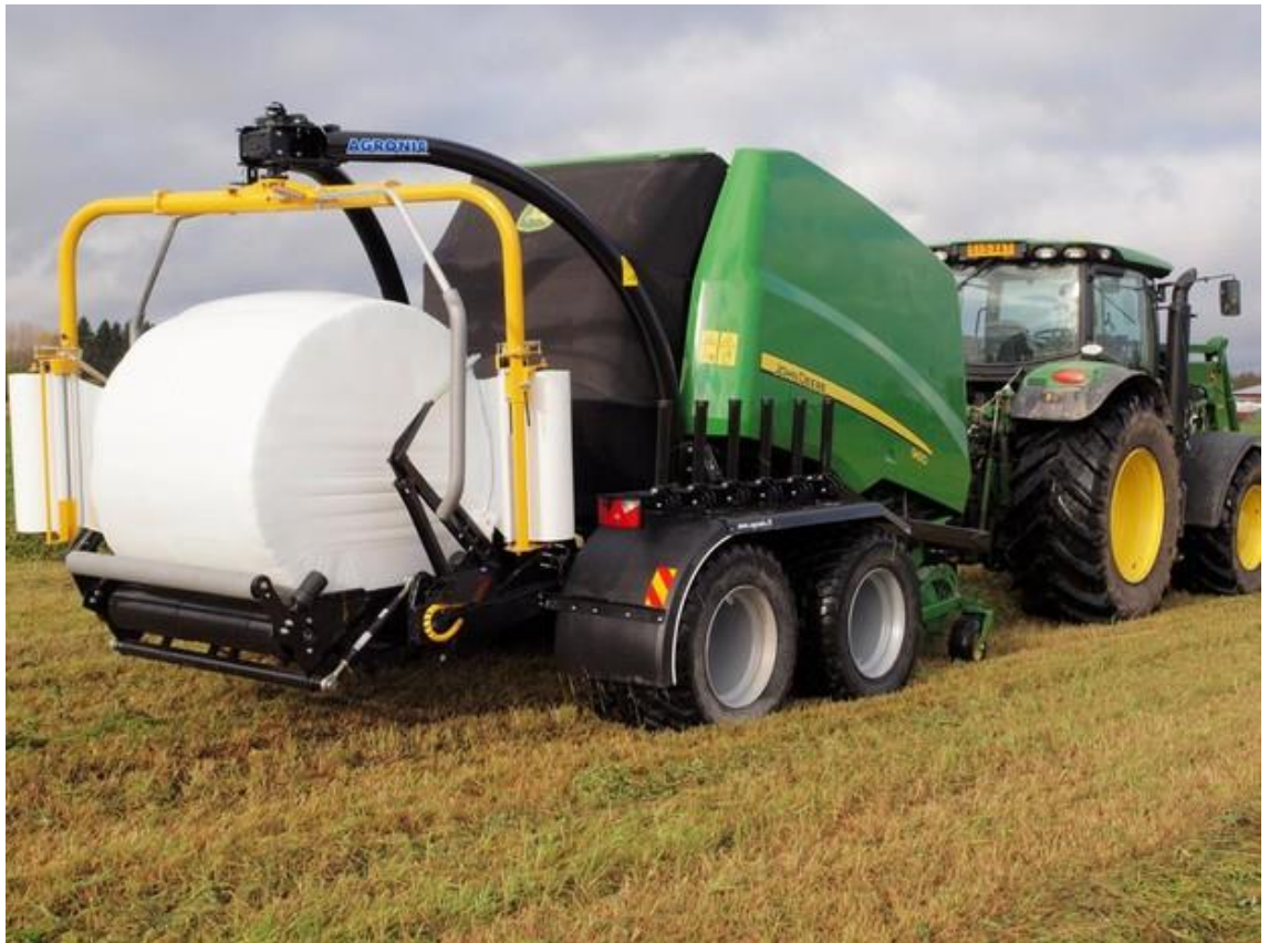
Kuva 5. Hyödynnettäessä yhdistelmäpaalainta paali siirtyy sidonnan jälkeeseen suoraan muovikäärintään. (Koneviesti 2016)
