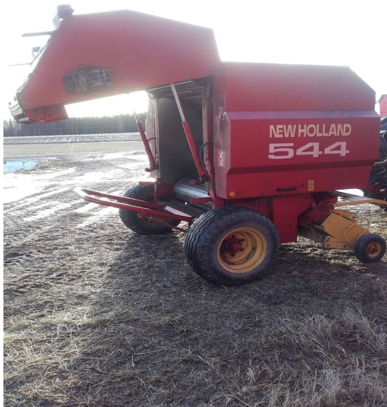
Kuva 4. Tavanomaisella pyöröpaalaimella paalatessa paalikammio avataan paalin valmistuttua ja pudotetaan pellon pinnalle. (Mattila 2016)
