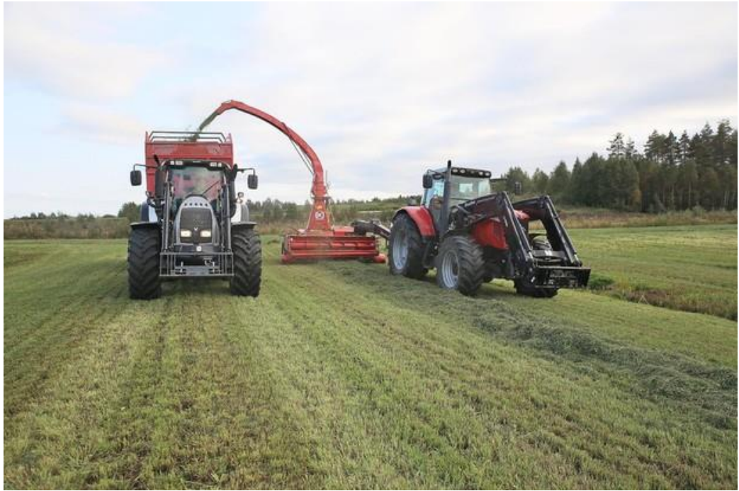
Kuva 9. Tarkkuussilppuria hinataan traktorilla. (Koneviesti 2017).
