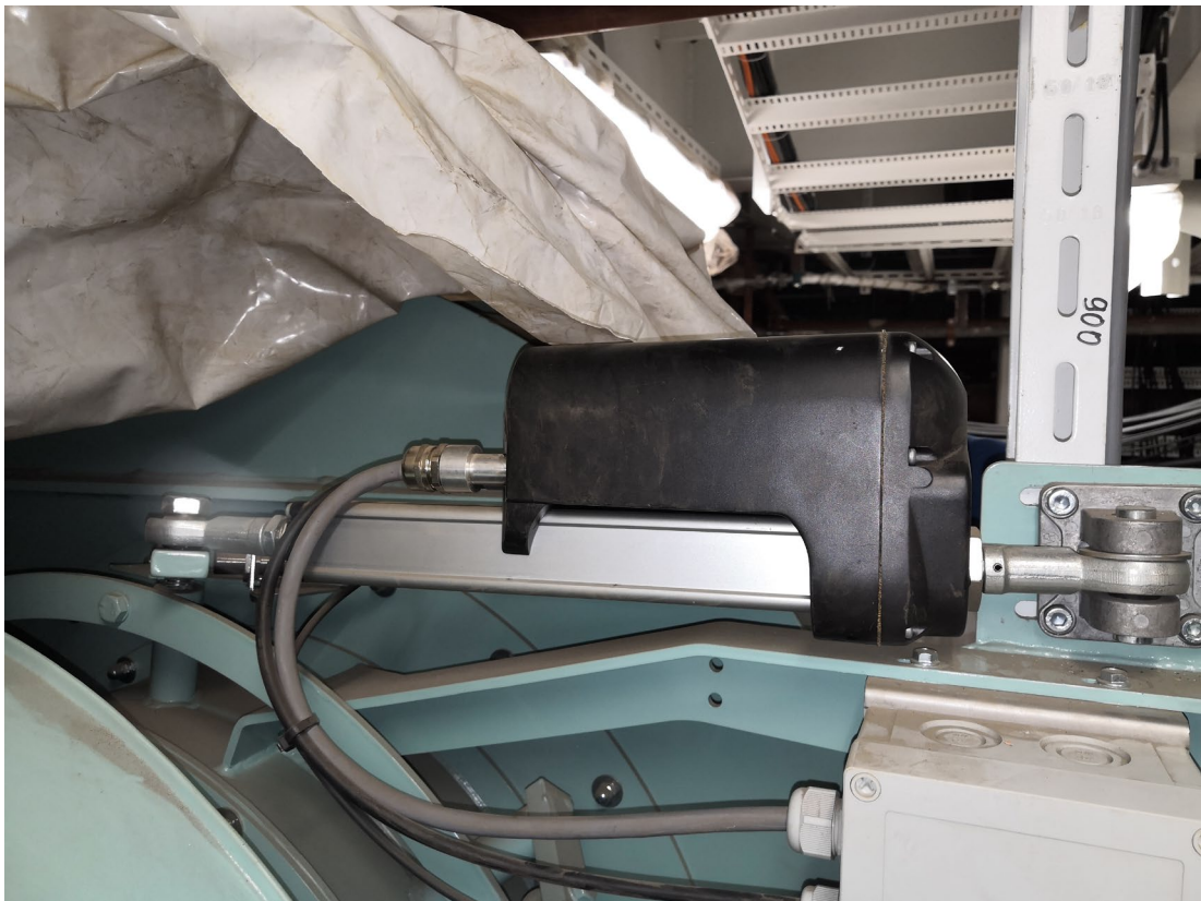
Kuva 7. Linak aktuaattori asennettuna ja kytkettynä säätöpeltiin. (Alfa Laval Aalborg Oy:n sisäinen tietokanta 2020)
