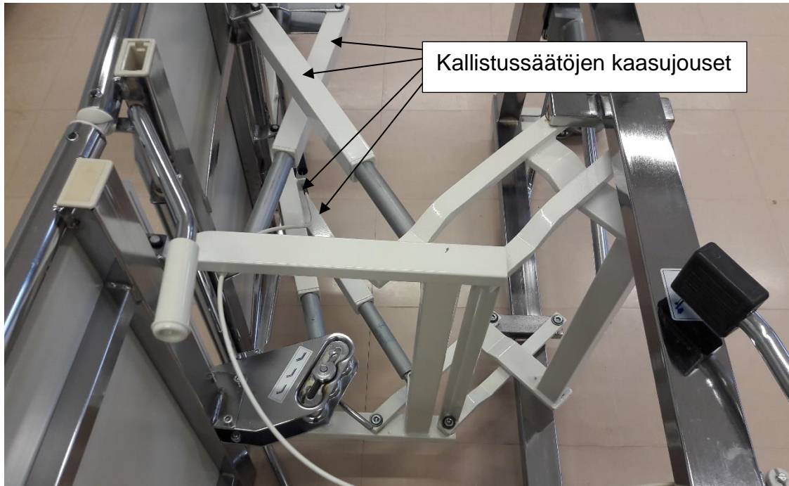
Kuva 7. Lukitusmekanismin tarvitsevat kaasujouset
