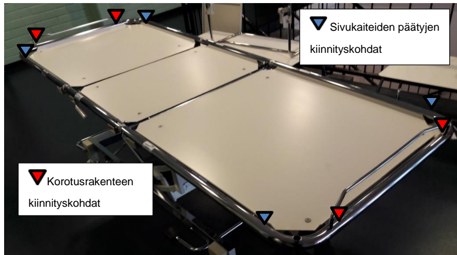
Kuva 14. Korotusrakenteen ja sivukaiteiden paikat
