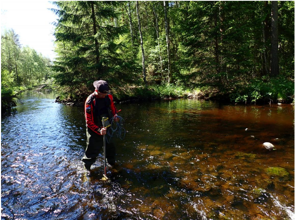
Kuva 7. Kenttätutkimuksissa virtausnopeuden mittaukseen käytettiin ELY-keskuksen siivikkoa (Kuva: Teppo Linjama).
