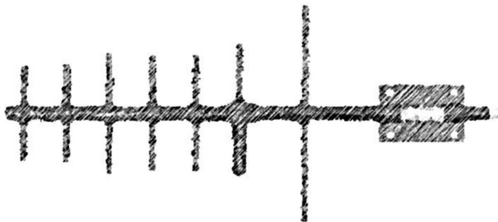
Kuva 19. Luonnos tyypillisestä yagi-tyyppisestä suuntaavasta antennista.
