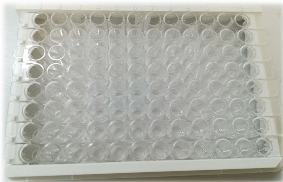
Kuva 6. Mikrotiiterilevy on 96- kuoppainen levy, joka on rakennettu levykehiksestä ja kahdeksasta erillisistä 12 kuoppiasesta stripsistä.
