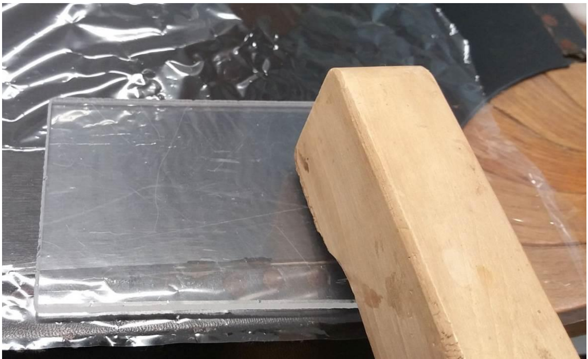
Kuva 33. Pohjaviilun kulman kiinnitystä
