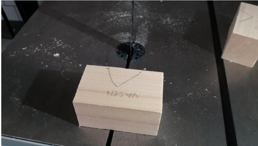
Kuva 21. Muoto leikattiin vannesahalla
