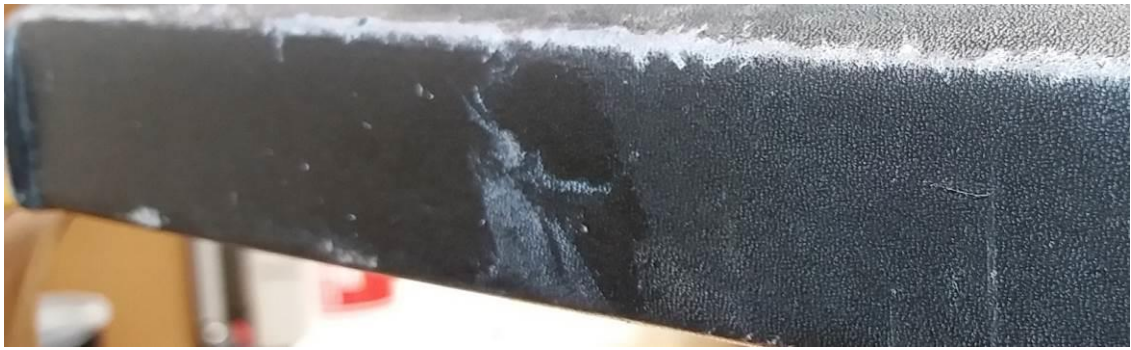
Kuva 46. Valkoinen läiskä käsitelty ligroinilla jonka päälle on levitetty Lederbalsamia
