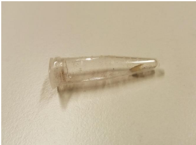
Kuva 13. Lakan pala FTIR:ää varten
