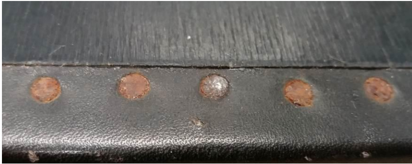
Kuva 42. Puhdistettu naulan kanta
