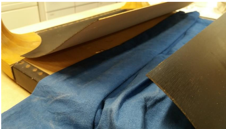
Kuva 28. Lähikuva pohjaviilun kostuttamisesta
