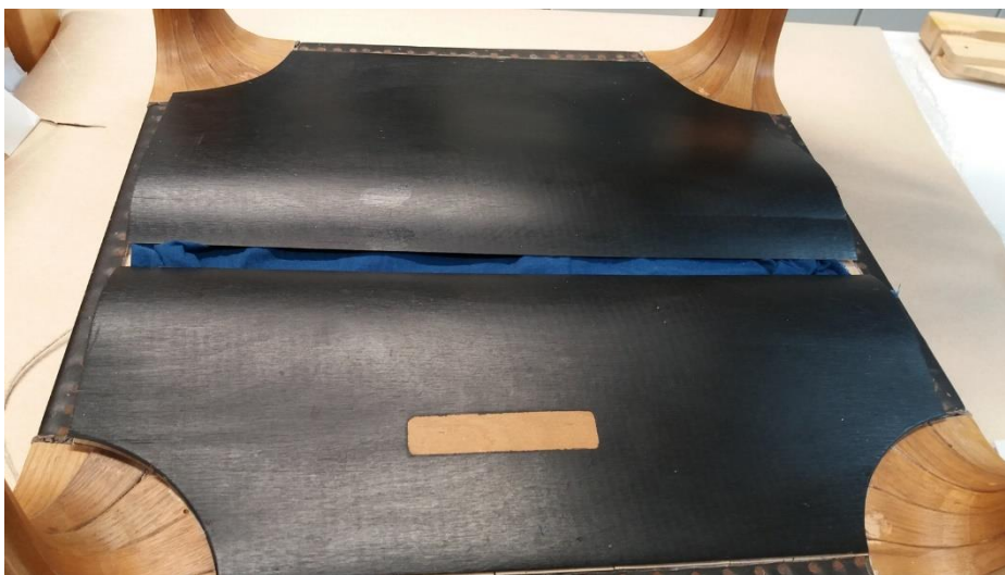
Kuva 26. Pohjaviilu kostutuksen alussa
