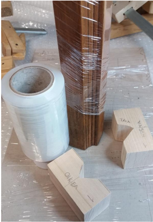
Kuva 24. Vasen: valmistelua ennen liimausta. Oikea: yhden jalan kokoonpano
