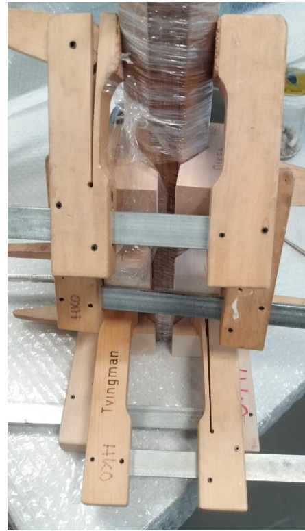
Kuva 24. Vasen: valmistelua ennen liimausta. Oikea: yhden jalan kokoonpano
