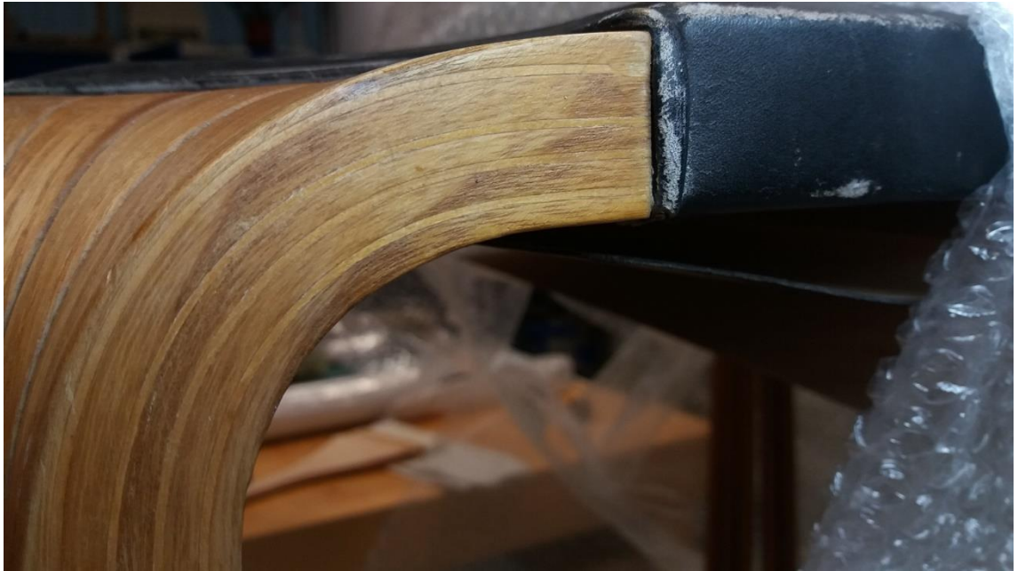
Kuva 7. Jalan taite jossa näkyy sen lamellit
