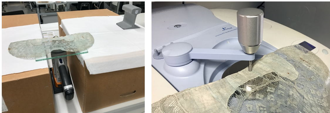
Kuva 20. XRF-mittauksia varten pitseille rakennettiin laatikoista tuki, jotta mittapäästä vasten oli vain mitattava kohde.
