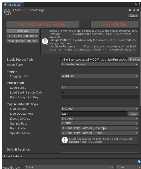
KUVA 25. FMOD asetusräky Unityn inspector ikkunas
