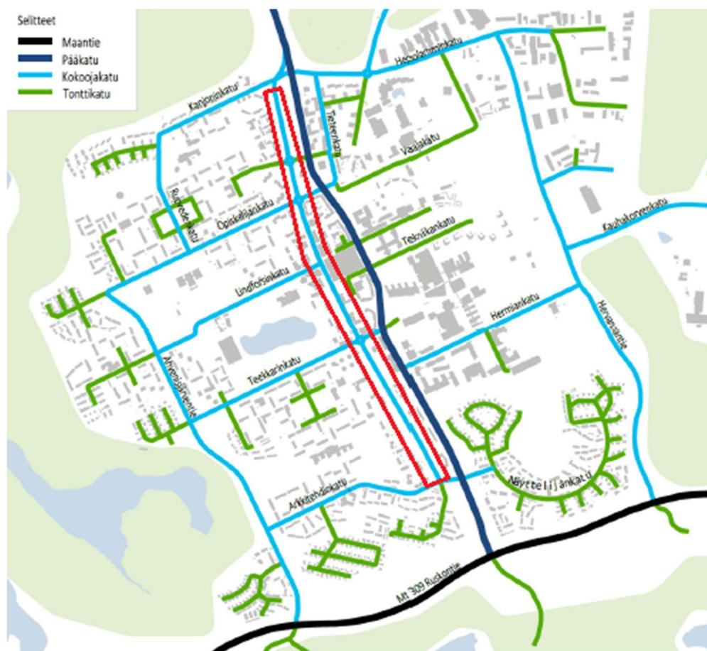
Kuva 19. Moottoriajoneuvoliikenteen väylien toiminnallinen luokitus Hervannassa. Insinöörinkatu kehystetty punaisella. (Alkuperäinen kuva: Tampereen kaupunki, 2019)
