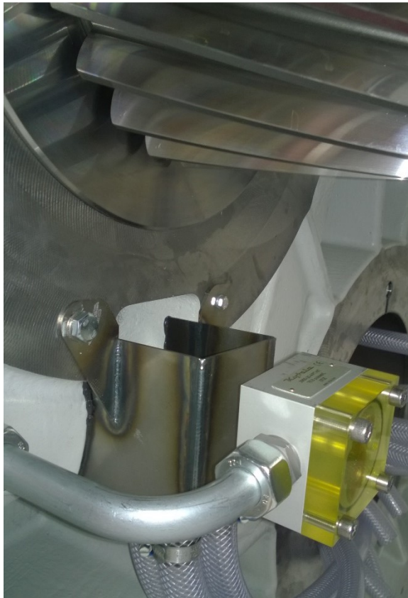
Kuvio 17. Manuaalisen virtausmittauspisteen B12/B13 öljynkeräyskaukalo sekä M5 mittauspisteen virtausmittari
