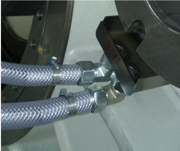
Kuvio 18. Manuaalisen virtausmittauspisteen B11 öljynkeräyskaukalo
