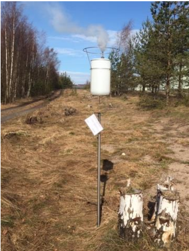
KUVA 1. Työssä käytetty laskeumakeräin
