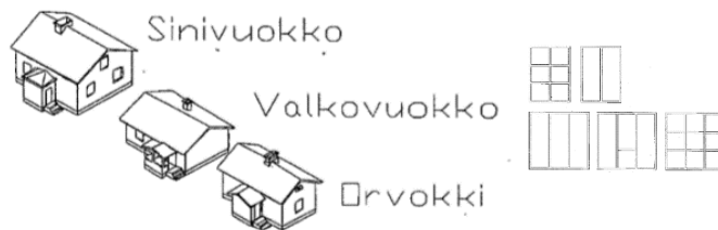
KUVA 8. Luttilan tyyppitaloja ja ikkunatyyppejä (Luttilan rakentamistapaohjeet 2001)
