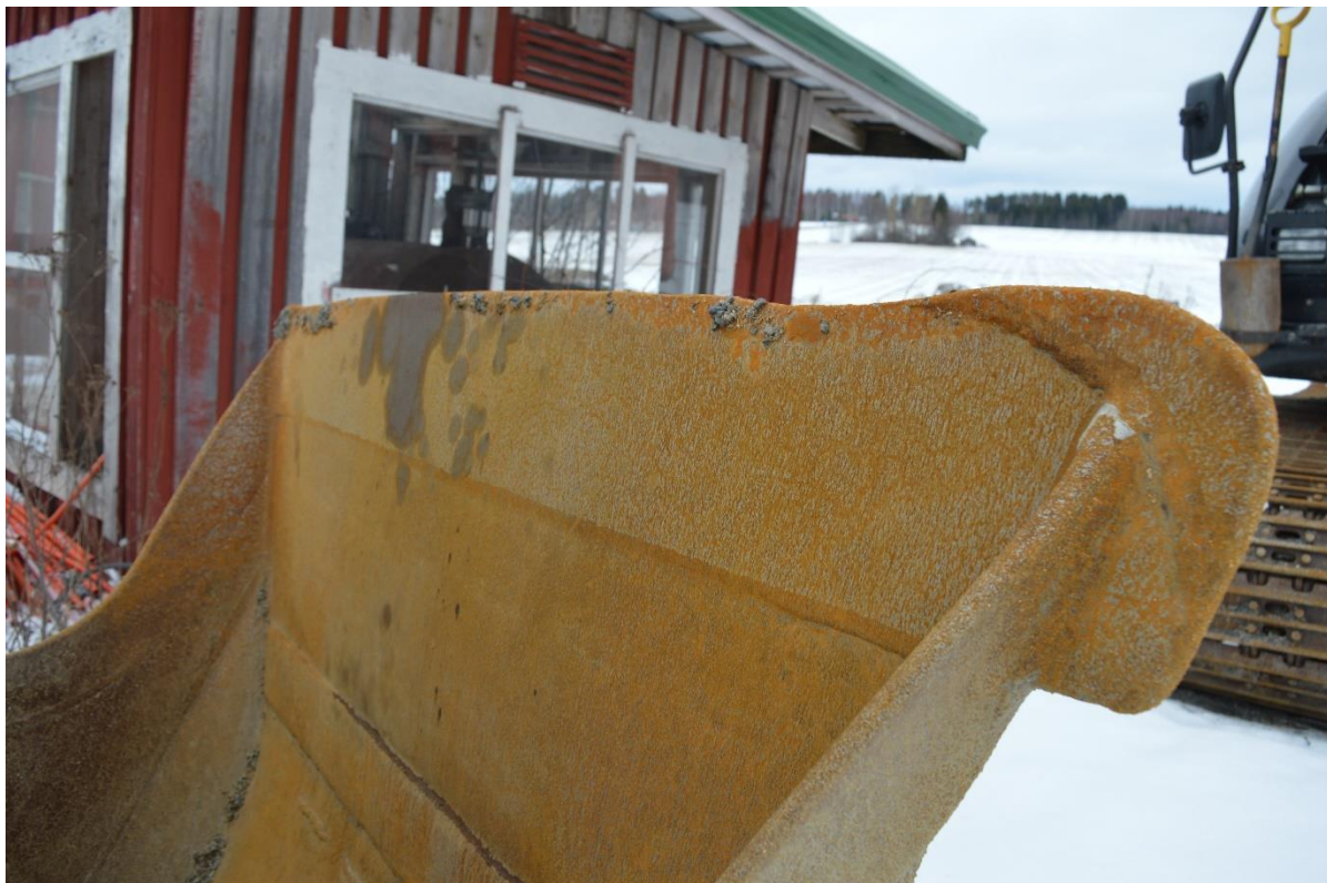
KUVA 7. Luiskakauha ja sen kulunut huulilevy (Airaksinen 2020-03-07)
