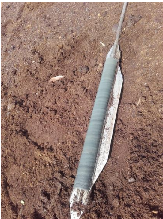
KUVA 4. Näytteenotossa käytetty kaira avattuna, jossa on näytteenä savea
