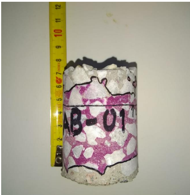
Kuva 6. Betonilieriönäyte, joka on käsitelty fenoliftaleiiniliuoksella.
