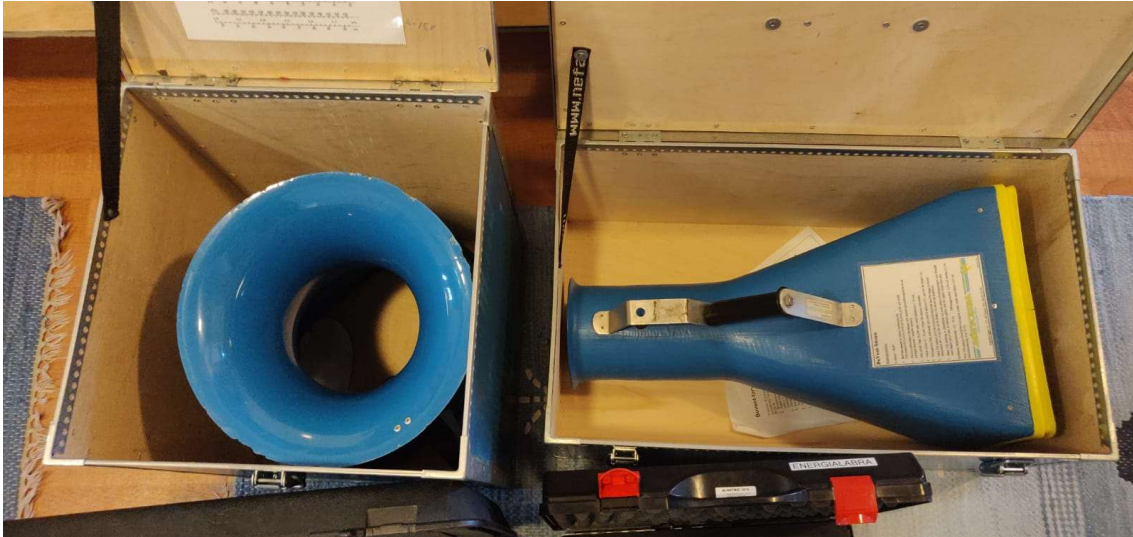
KUVA 11 Mittauksessa käytetyt mittaustorvet
