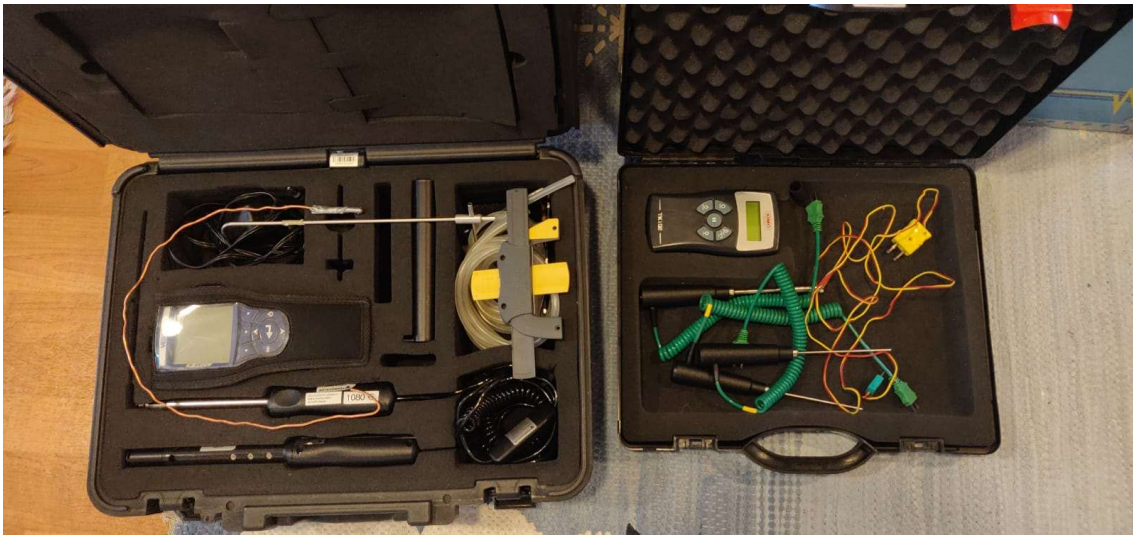
KUVA 10 VelociCalc-monitoimimittari ja KIMO-pikalämpömittari
