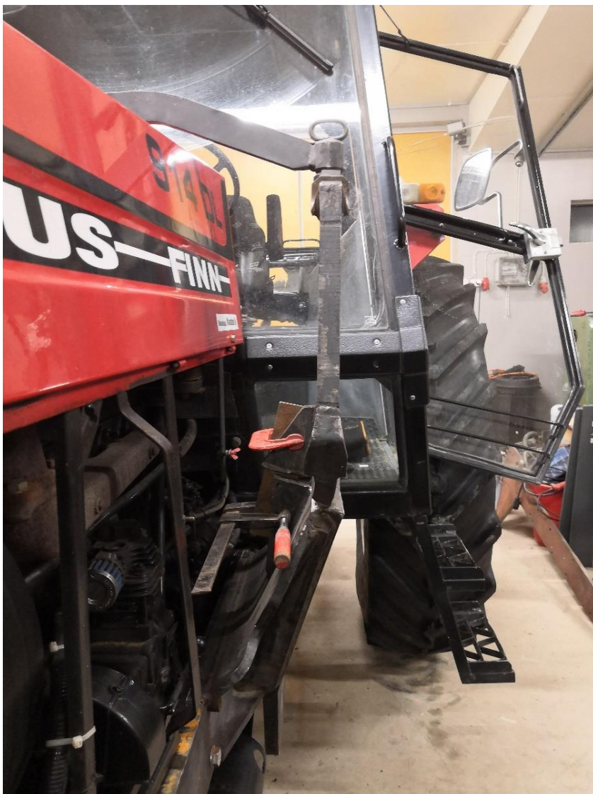
Kuva 4. Sovitteen katkaisu ja kavennus. Alhaalla näkyy myös sovitteen alapää, jota on taivutettu kauemmas etuvedon kardaanista.
