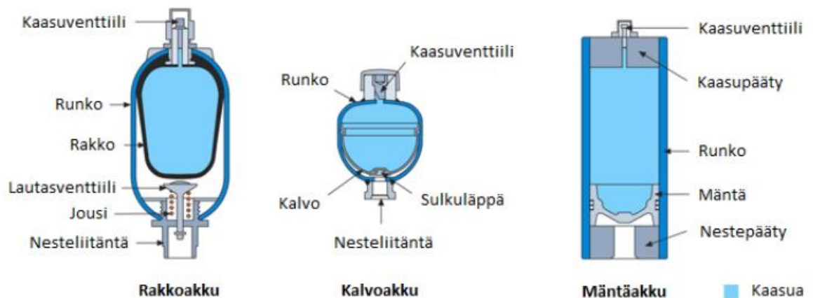
Kuva 7. Periaatekuva erilaisista paineakkutyypeistä (Autiosalo 2017,4)
