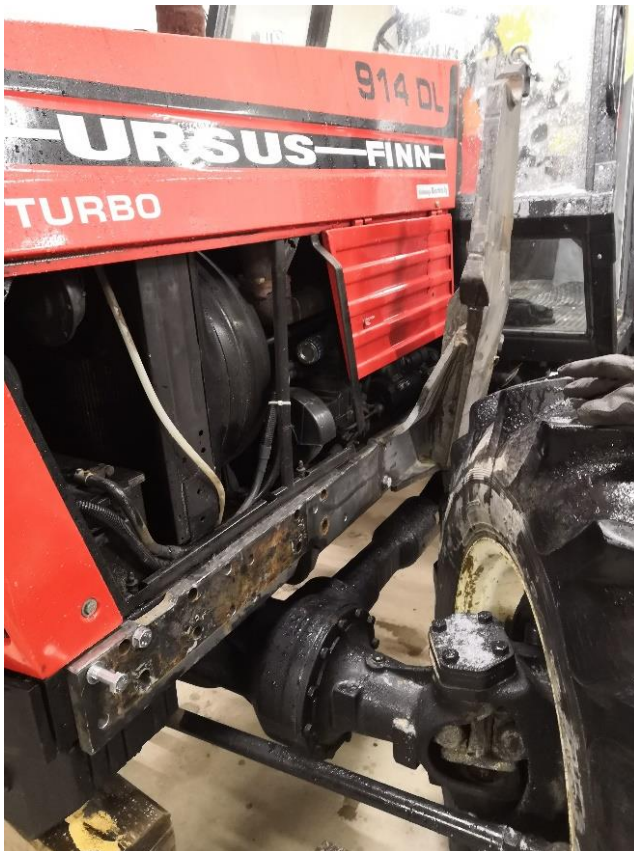
Kuva 3. Etupään sovite kiinnitettyä traktoriin.
