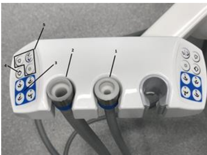
Kuva 8. Flexy-teline. Kuvassa 1. pikkuimu, 2. tehoimu, 3. tuolipainikkeet, 4. Flexy-painike, 5. hoitokonepainikkeet.
