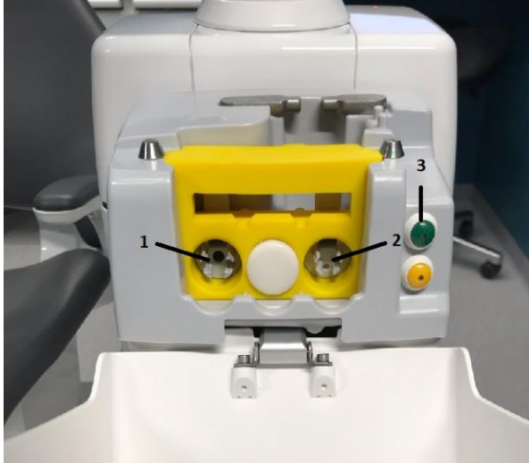
Kuva 11. Orotol-puhdistusteline. Kuvassa 1. paikka tehoimulle, 2. paikka pikkuimulle, 3. käynnistyspainike.
