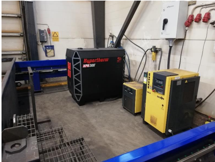
Kuva 15. Virtalähde Hyperterm XPR300, kompressori ja kuivain.
