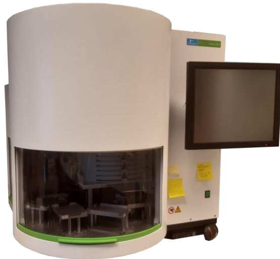
Kuva 8. PerkinElmer chemagic™360 on puoliautomaattinen nukleiinihappojen eristyslaite.
