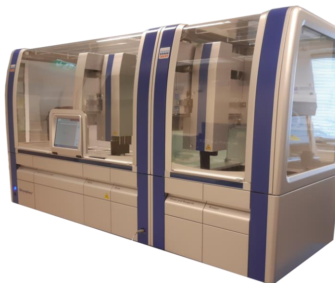
Kuva 10. QIASymphonySP/AS koostuu eristys- ja PCR-pipetointi-moduuleista.
