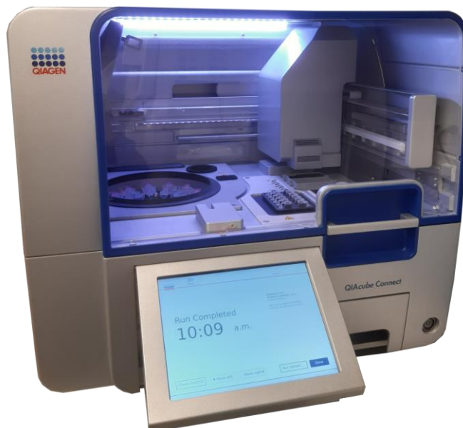
Kuva 7. Uuden sukupolven QIAcube Connectissa on suuri kosketusnäyttö, jolla laitetta käytetään.
