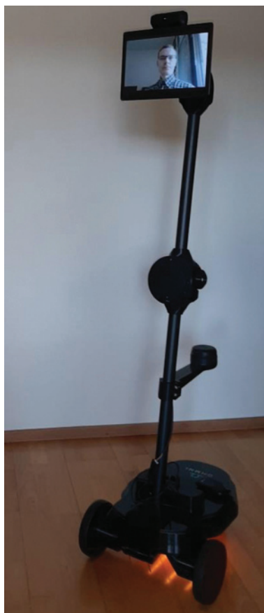
Kuva 9. Ohmni-roboti, jolla videopuhelu käynnissä. Varresta taakse päin ulkoneva osa on esteentunnistukseen käytettävä laser-tutka. Puolivälissä vartta on kaiutin-mikrofoni ja virtakytkin.
