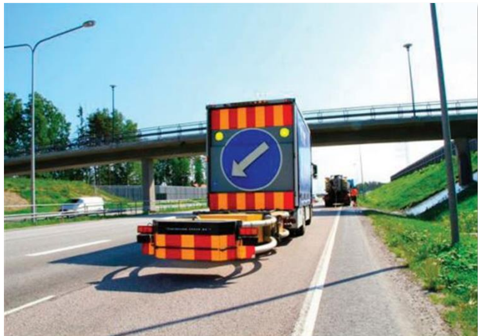
Kuva 2. Törmäysvaimentimella varustettu suoja-auto (kuva: Mika Schroderrus - YIT kalusto).
