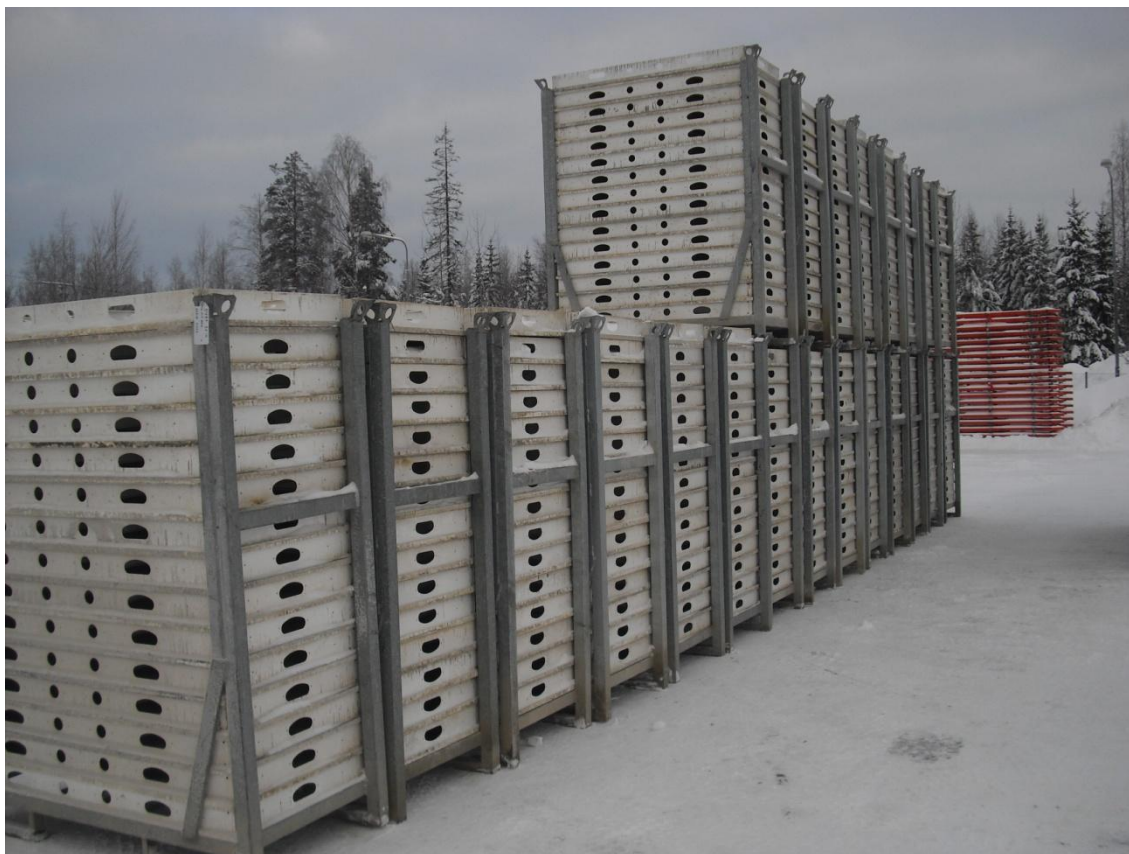
Kuva 7. Skydeck-muotit varastoituna Peri Suomen Hyvinkään toimipisteessä (Tarvainen PERI Suomi Oy).
