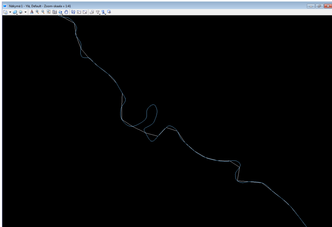
Kuva 12. Ankkuroidun viivan ja alkuperäisen kantakarttakohteen välinen vertailu. Kuvasta näkyy, että tiiviimmät kaarteet ja mutkat ovat puskuroinnin ja ankkuroinnin aikana leikkautuneet ja oikaistu.
