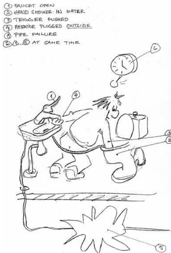
Kuva 34. Mallinnos ejektorilla toteutetun bideekäsisuihkun takaisinimutilanteesta. Piirros: Pekka Nilsson, Oras Group. [54]
