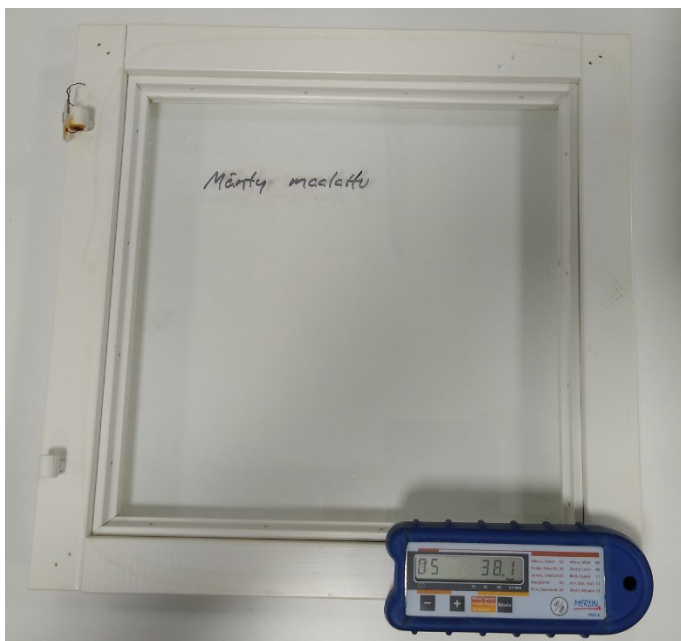
Kuva 29. Kosteusmittaus Merlin -kosteusmittarilla puitesivun eri kohdista
