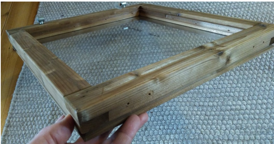
Kuva 26. Maalamaton lämpökäsitelty kuusi säärasituksen jälkeen
