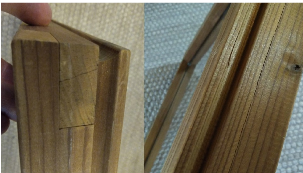
Kuva 27. Lämpökäsittelyssä puussa näkyviä halkeamia männyssä ja oikealla kuusessa
