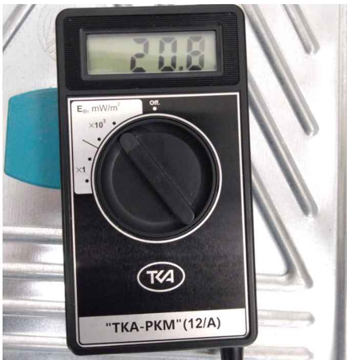
Kuva 13. Valotehon mittaukseen aalloalueella (315...400 nm) käytetty mittari
