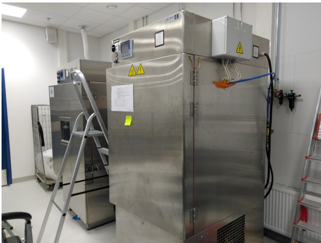
Kuva 4. Säärasitustestauksessa käytetyt olosuhdekaapit
