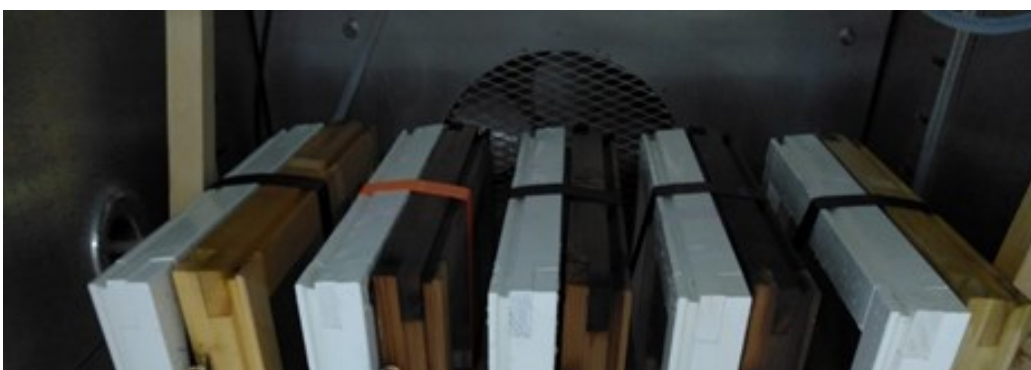
Kuva 7. Yhteensidottujen puitteiden sijoittelu olosuhdekaapissa
