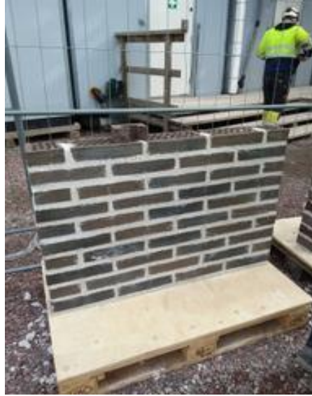
Kuva 4.4 Umpeen muurattu tiiliseinä (Malli 1)
