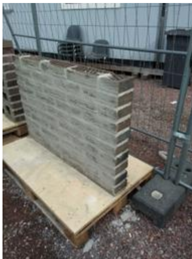
Kuva 4.8. Umpeen muurattu tiiliseinä (Malli 2)
