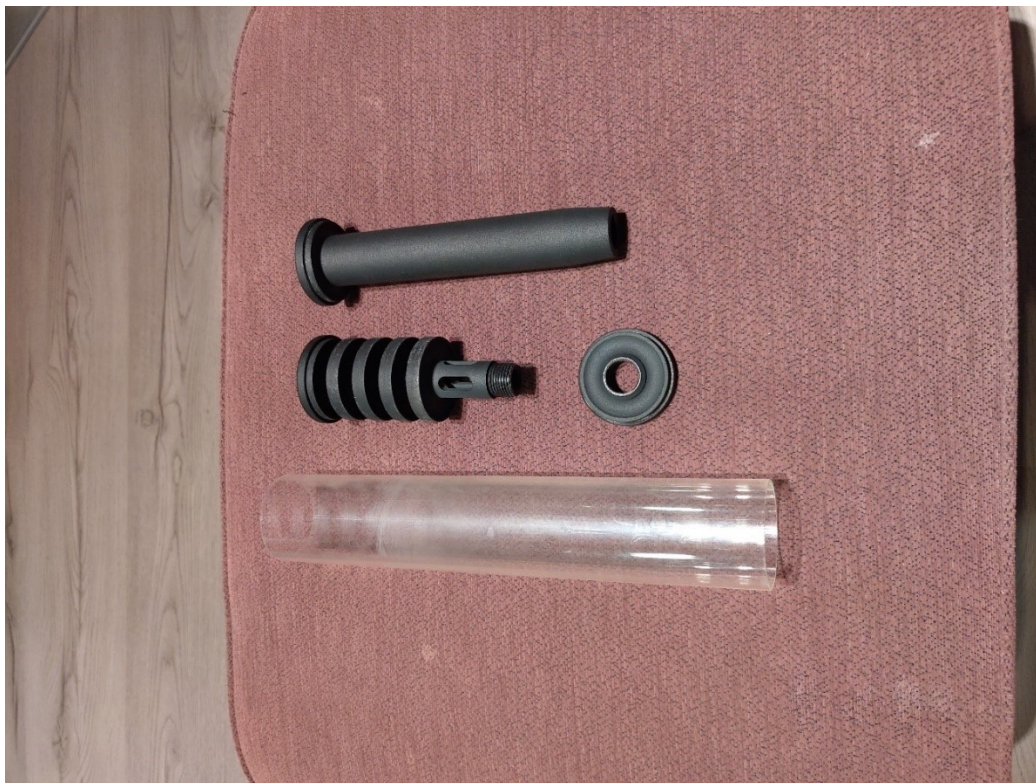
KUVA 7. Äänenvaimentimen prototyyppi. (Martikainen 2020.)
