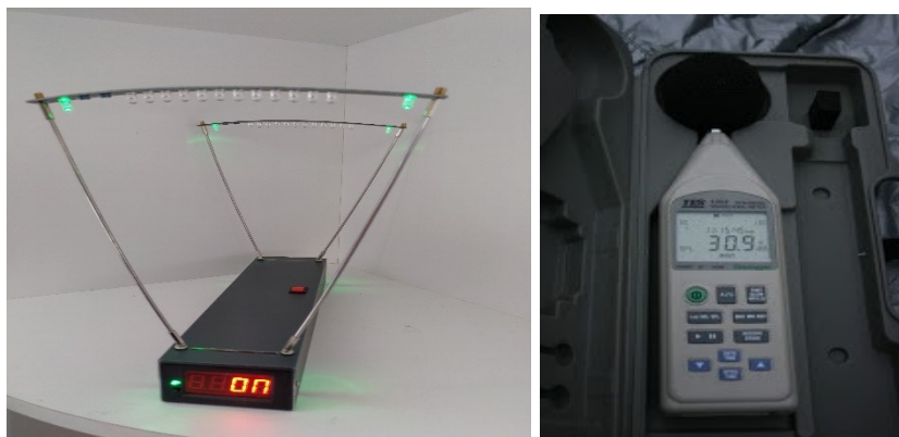
Kuva 15. Luodinnopeusmittari ja desibelimittari. (Martikainen 2020.)
