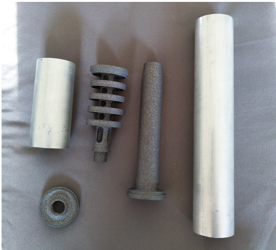
Kuva 8. Valmiit vaimentimen osat. (Martikainen 2020.)
