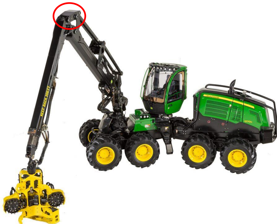
KUVA 1. 1270G Harvesteri CH7 -puomilla. H-pala ympyröity. (John Deere 2020)
