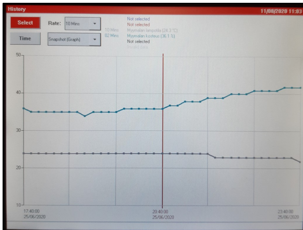
Kuva 27. Kaupan sisälämpötila ja ilmankosteus 25.6. klo 18:00–23:40.
