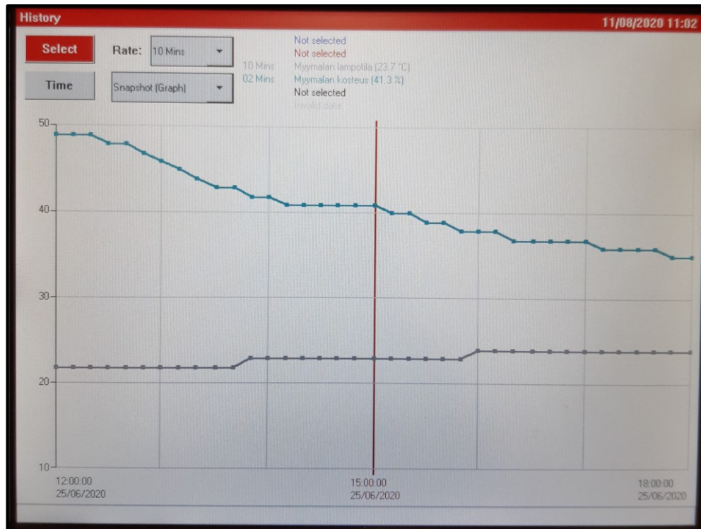
Kuva 26. Kaupan sisälämpötila ja ilmankosteus 25.6. klo 12:00–18:00.
