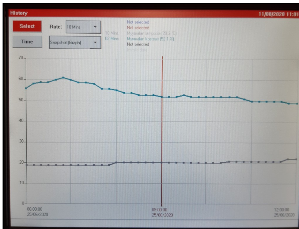
Kuva 25. Kaupan sisälämpötila ja ilmankosteus 25.6. klo 06:00–12:00.
