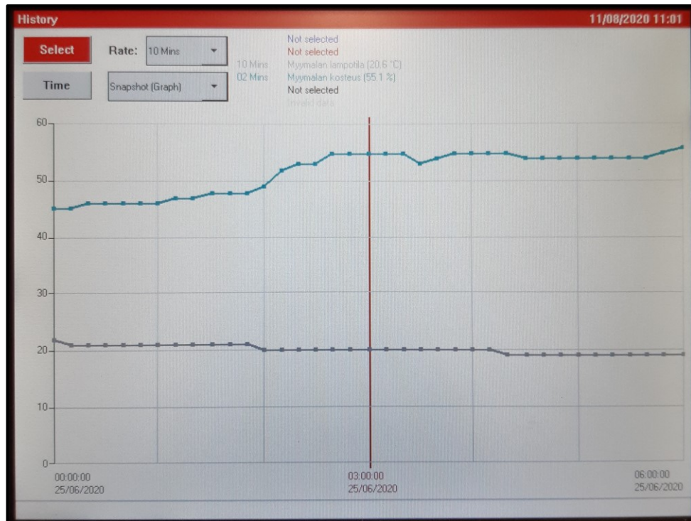
Kuva 24. Kaupan sisälämpötila ja ilmankosteus 25.6. klo 00:00–06:00.
