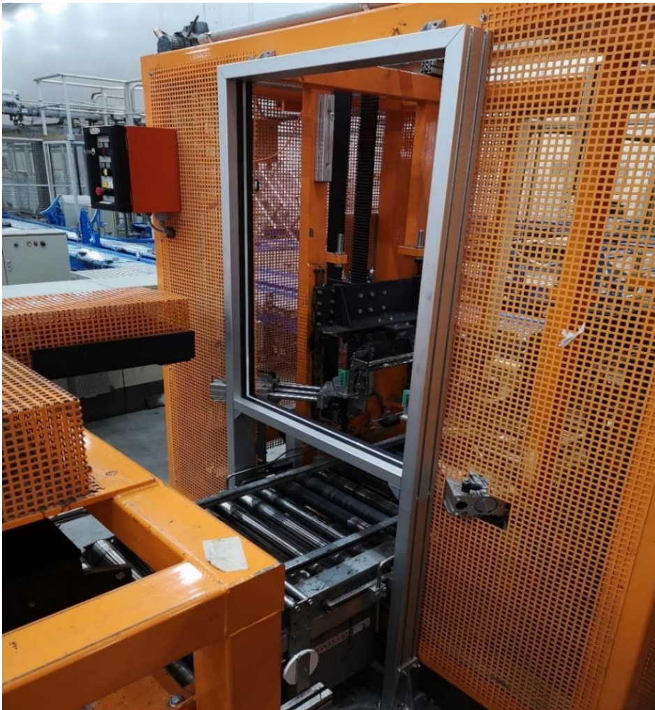
Kuva 15. Sisääntulopuolen portti asennettuna
