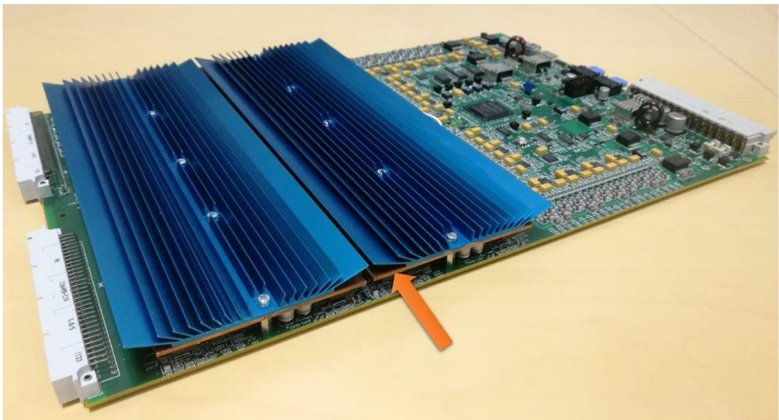
Kuva 2. Jäähdytettävä kaksiosainen piirikortti, jossa kiinnitettynä ilmajäähdytykseen käytettävät siniset jäähdytyslementit. Oranssi nuoli osoittaa pienempää kuparista piirikorttia, jonka alapuolella kuumenevat vahvistinkomponentit sijaitsevat.
