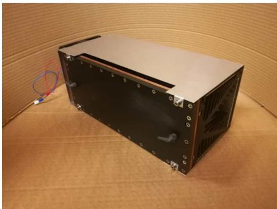
Kuva 19. Kokoonpantu lämmönvaihdin. Osien tilaamisen jälkeen lämmönvaihtimen koteloon li- sättiin liitin tuulettimen johdoille.
