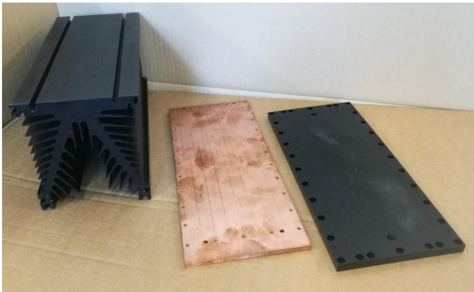
Kuva 8. Suunnitellun lämmönvaihtimen osia. Jäähdytyslementin pohjassa näkyvät puristussoviteen urat.
