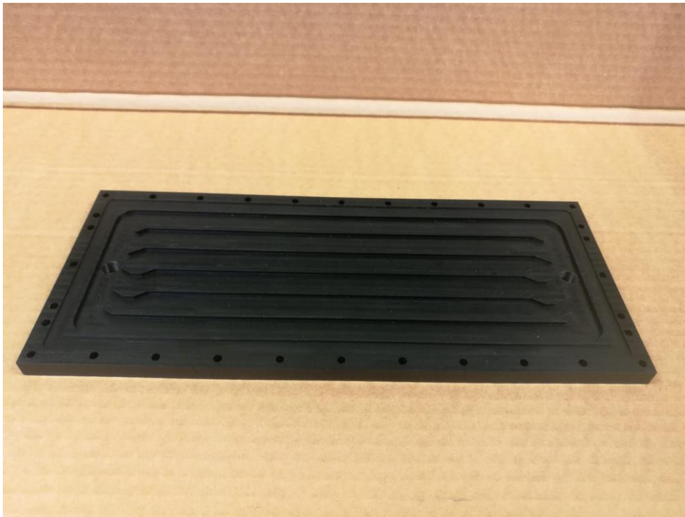
Kuva 9. Kuparilevyä vasten asennettava vesiblokki, jossa kehällä uloimpana kiinnitysruuvien paikat. Reikäkehän sisäpuolella näkyvä tiivisteura sekä keskellä vesikanavat.
