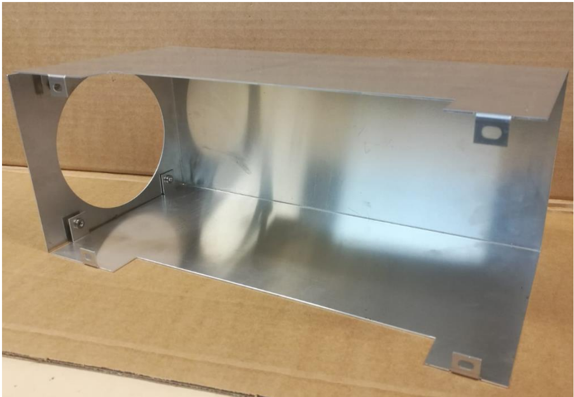
Kuva 15. Lämmönvaihtimen kotelo, jossa käytettiin PEM-puristemuttereita tuulettimen kiinnitystä varten.
