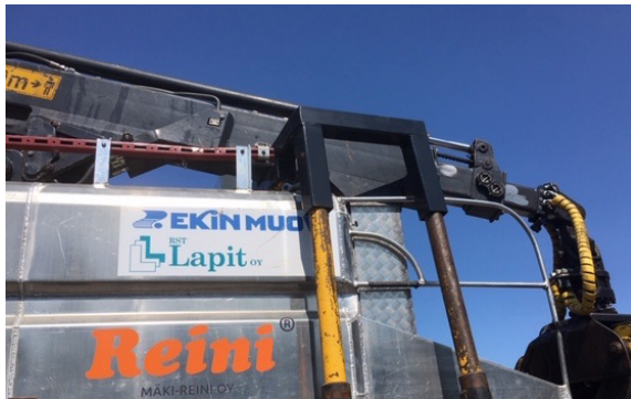
KUVA 18. Puomin tukirauta ja turvavaljaiden kiinnityspiste
