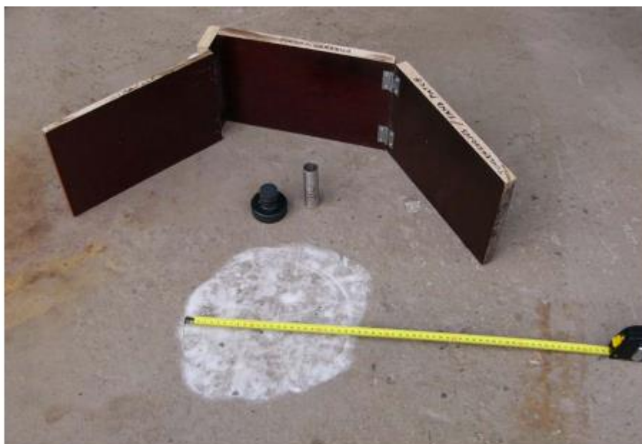
KUVA 7. Eristysalustan pinnankarkeuden mittausvälineet. (Sillan vedeneristystyömaan laadunvarmistus 2017).
