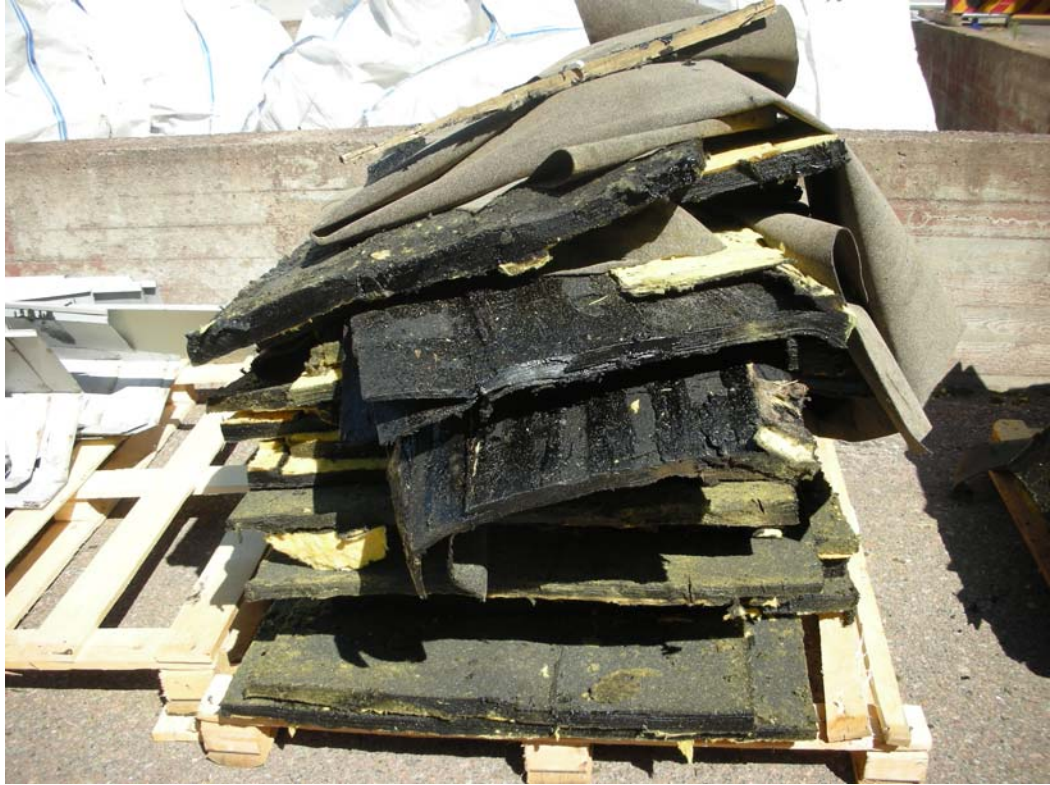
Kuva 6. Vanhan puretun kermikerroksen kappaleita
