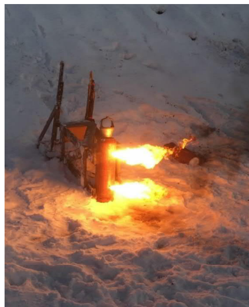
Asetyleenipulloon on ammuttu kaksi reikää valojuovaluodilla kaasun ulosvirtauksen lisäämiseksi (Kenttäkoe 2, kuva tekijän)
