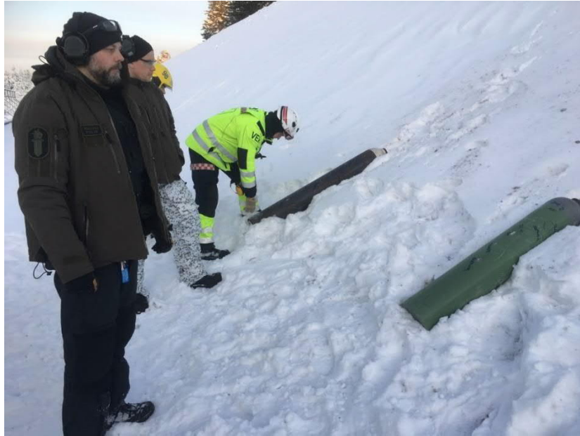
Pullon kulma rinteessä, jolloin mikään luoti ei enää läpäissyt pullon vaippaa. (Kenttäkoe 2, kuva tekijän)
