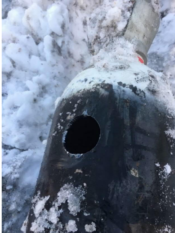
Polttoleikkausreikä happea sisältäneen pullon osumakohdassa. (Kenttäkoe 2, kuva tekijän)
