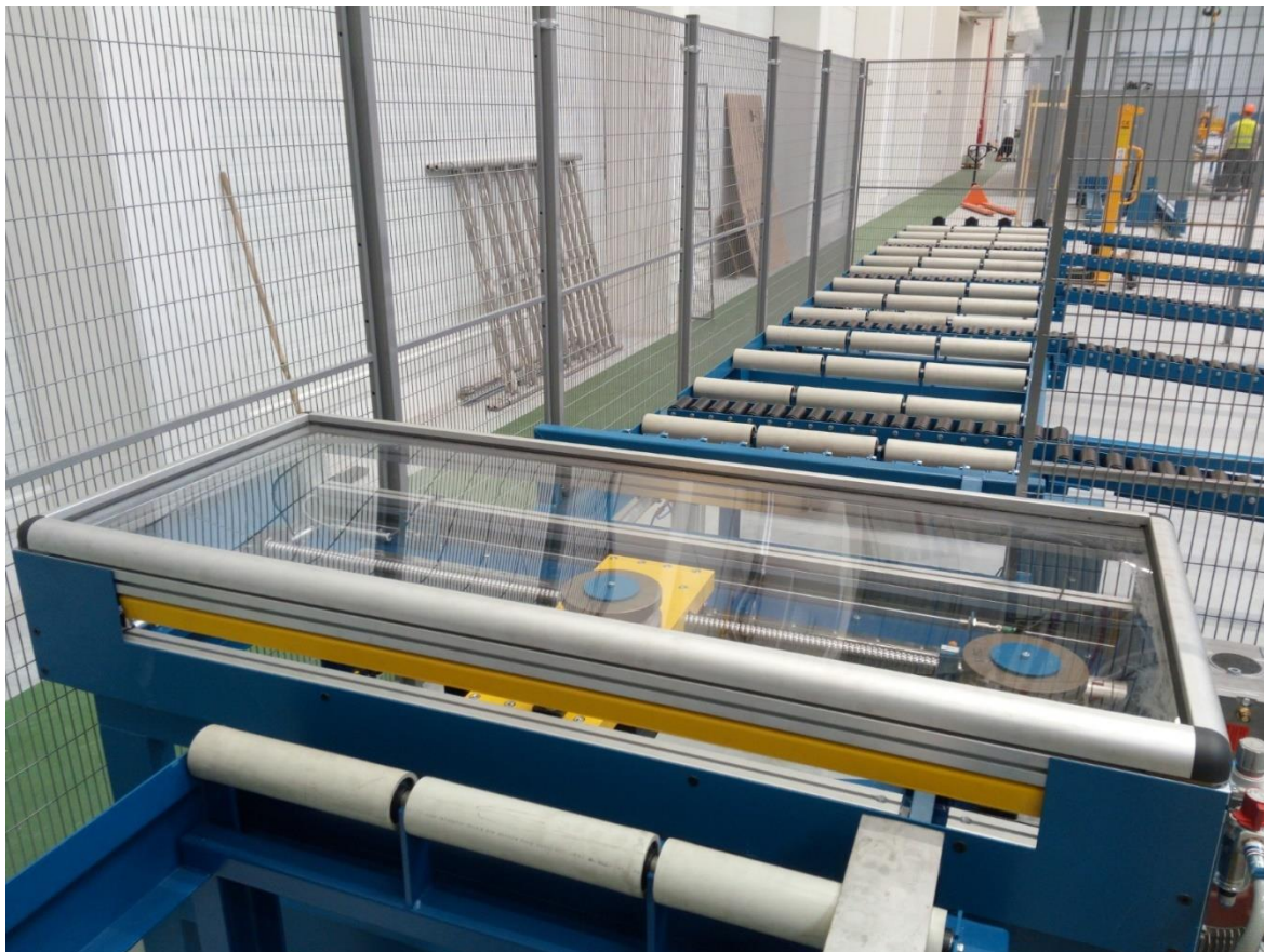
Kuva 17. Levyä tyssäävän yksikön suoja (Kananen 2019)
