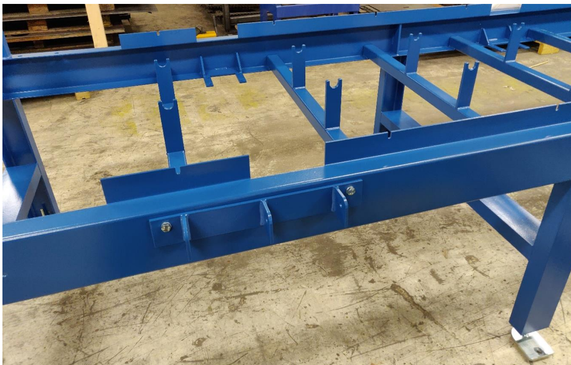
Kuva 7. Laserleike-runko ja rullien kannakkeet
