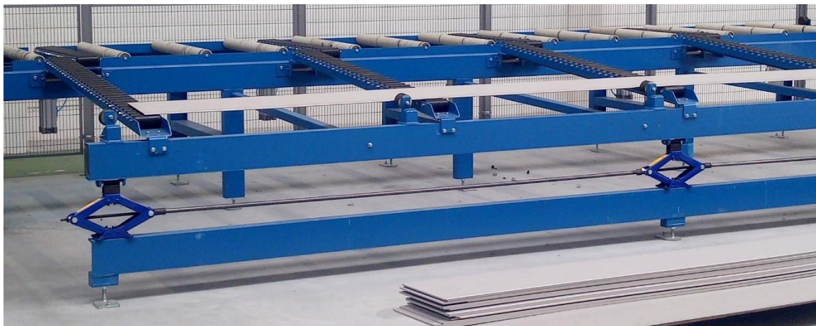
Kuva 15. Säädettävä painovoimainen sivurata (Kananen 2019)
