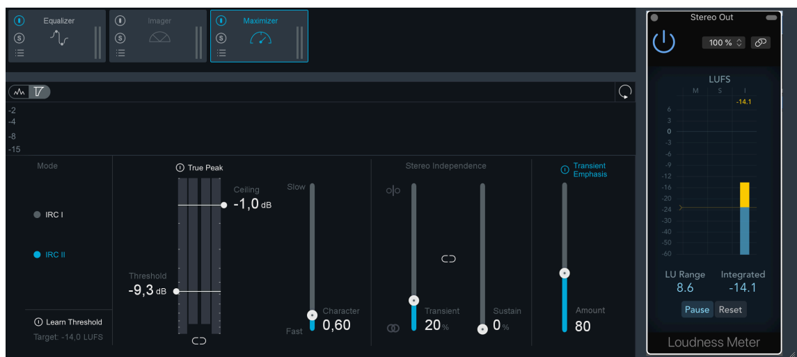
Kuva 21. Rajoittimen avulla halutun -14 dB LUFS -äänekkyystason saavuttaminen.
