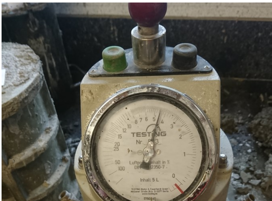
KUVA 2. Ilmamäärämittaus tuoreesta betonista ilmamäärämittarilla
