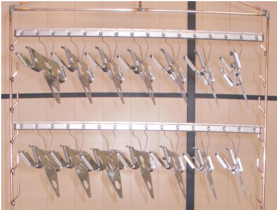
KUVA 6. Optimaalinen ripustusasento kattokiinnikkeelle.
