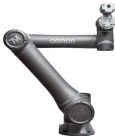
Kuva 5. Omron TM-yhteistyörobotti, jolla on integroitu kamera [16].
