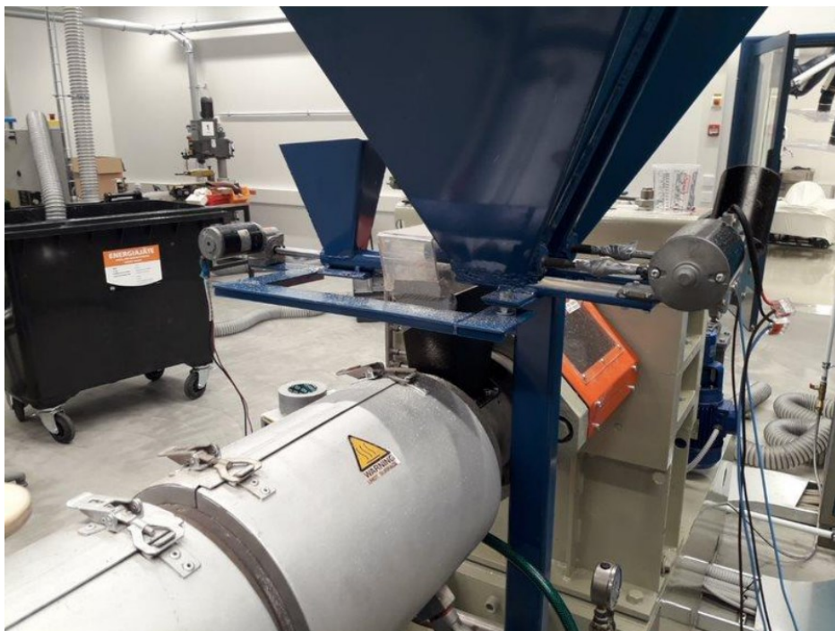
Kuva 4. A.S.T. -yhtiön valmistaman ekstruderin annosteleva syöttöjärjestelmä (Heikkinen 2020.)
