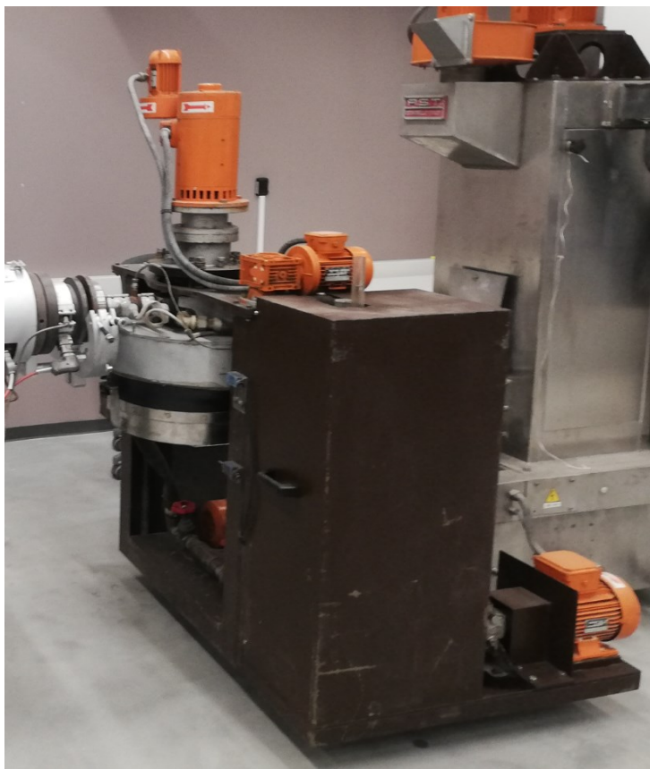
Kuva 15. A.S.T. -yhtiön valmistama granulaattori, jonka takana näkyy granulaattien kuivausrumpu
