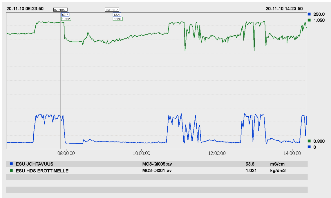
KUVIO 17. Suovan johtokyky ja tiheys (Valmet DNA -automaatiojärjestelmä 2020b.)
