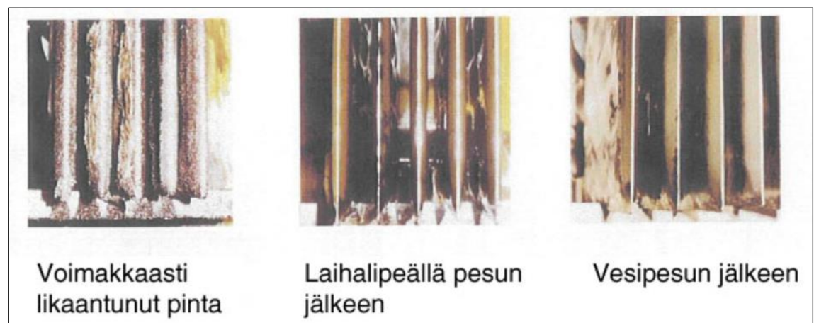
KUVA 11. Likaantunut ja pesty mustalipeähaihduttimen lämmönsiirtopinta (Knowpulp 2020g.)
